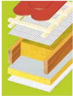
Altes Sparrendach mit 8x16 cm Sparren, dazwischen Mineralwolledämmung, Dämmqualität (WLS) 035, darunter 6 cm Polyurethandämmung mit beidseitiger Metallkaschierung, Dämmqualität (WLS) 024
