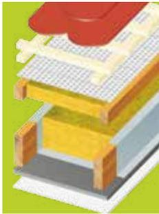
Altes Sparrendach mit 8x16 cm Sparren, Aufdopplung mit 6x12 cm Konstruktionsvollholz, dazwischen Mineralwolledämmung, Dämmqualität (WLS) 035
