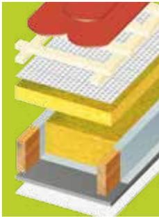
Altes Sparrendach mit 8x16 cm Sparren, dazwischen Mineralwolledämmung, Dämmqualität (WLS) 035, oberseitig 10 cm Aufsparrendämmung aus Holzfasерplatten, Dämmqualität (WLS) 040
