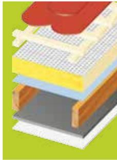
Altes Sparrendach mit 8x16 cm Sparren, oberseitig 18 cm Aufsparrendämmung aus Polyurethanplatten, Dämmqualität (WLS) 024
