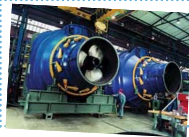
Turbine eines Wasserkraftwerks vor dem Einbau
